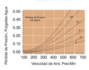
La Caída de Presión Estática a 2 a 2.5 m/s (400/500 pie/min) Velocidad, es de 0.40 inmg@400ppm ó 10.16 mmca@400ppm.
